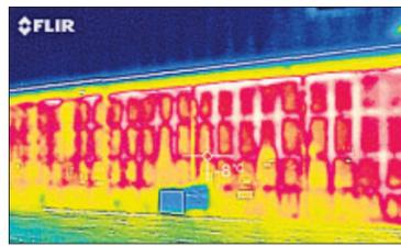
So zeigt sich heute der Wärmeverlust bei den Toren der Rowatec AG.
