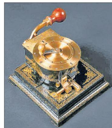
Als die Checknummern noch aus kleinen gestanzten Löchlein bestanden, kam dieser Checkperforator zum Einsatz.
