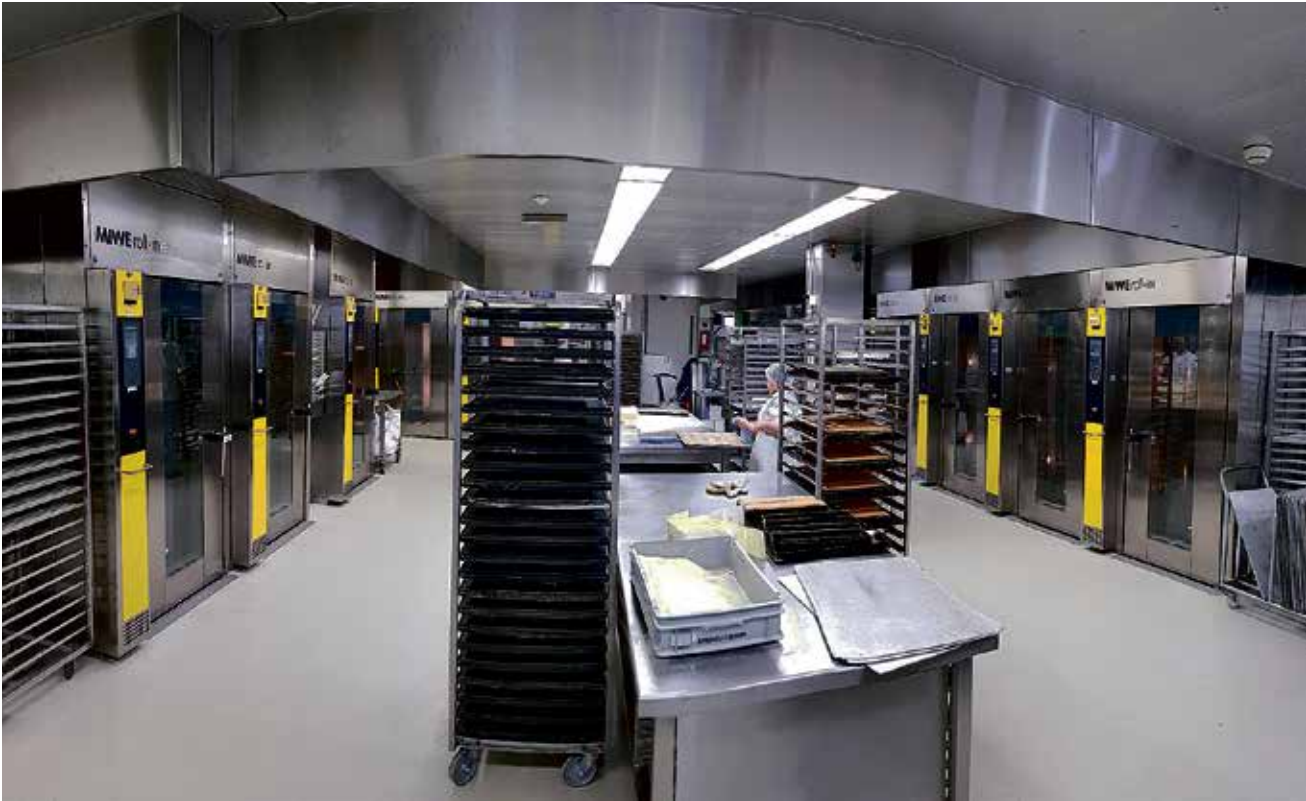
Die alten Backöfen wurden durch neue, energieeffiziente Öfen mit einem grösseren Wärmespeicher ersetzt.
